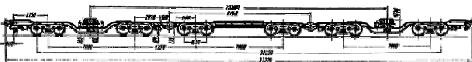
käntöalustoilla varustettu erikoisavovaunu pitkän tavarankuljetukseen kantavuudeltaan 120 tonnia
